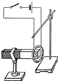
119. На столе собрана установка, в которой использован разборный электромагнит с одной катушкой и моток проволоки. Выяснить, будет ли двигаться моток, если замкнуть одну любую цепь, в каком направлении будет двигаться моток при замыкании обеих цепей, как изменить направление
