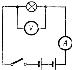
87. Отобрать приборы для измерения силы тока в электродвигателе и напряжения, под которым он работает. Начертить схему цепи, собрать эту цепь, снять показания приборов, объяснить, почему выбрали именно эти измерительные приборы.
